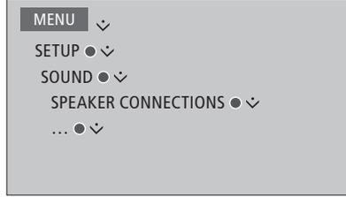
مهم! إذا اخترت LINE كنوع سماعة في قائمة SPEAKER CONNECTIONS، فإن حجم الصوت سيكون عالياً جداً ولا يمكنك ضبط حجم الصوت بواسطة وحدة التحكم عن بعد Beo4/Beo6. ويجب استخدام وحدة التحكم عن بعد الخاصة بالمنتج. تستخدم LINE، على سبيل المثال، مكبرات صوت ليست Bang & Olufsen.
