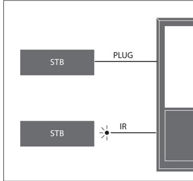
أثناء إعداد مصدر عن طريق قائمة SOURCE LIST SETUP، يمكنك اختيار كيفية توصيل منتج يتم التحكم فيه عن طريق PUC. ويمكنك الاختيار بين PLUG (كابل) وIR وBLASTER (مرسل IR). وإذا اخترت PLUG، فيجب أن تختار بين MODULATION ON وMODULATION OFF. لمعرفة معلومات عن نوع كابل وإعدادات التضمين، اتصل بتاجر تجزئة Bang & Olufsen.
